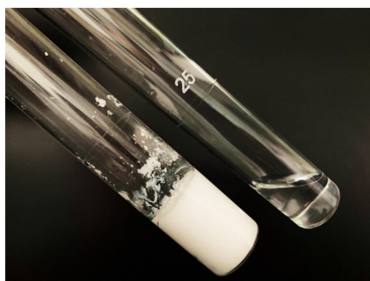
图2 添加造孔剂的大孔水凝胶(左)及不添加造孔剂的水凝胶(右)对比图
